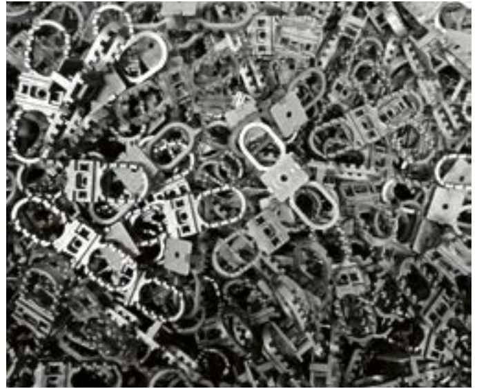
Terraflex und Terrafix aus bis zu 98 % PP-Regranulat
