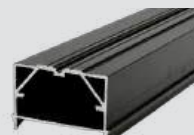
BIG-Isostep (Alu) 54 Terrassenlager Abstand Auflagepunkte max. 110 cm
