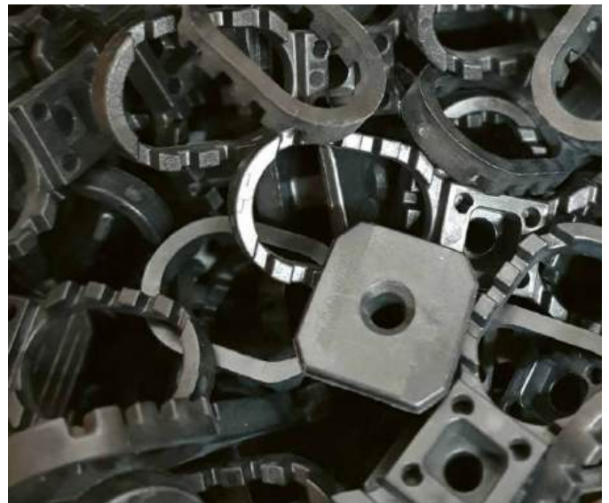
Terraflex und Terrafix aus bis zu 98 % PP-Regranulat
