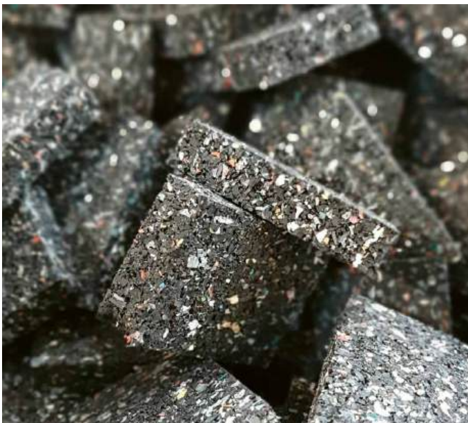
Isopads aus 95 % Altreifengranulat
